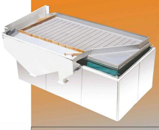
Las mesas densimétricas eliminan las impurezas ligeras de las semillas por medio de la separación por diferencia de peso específico.
